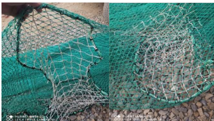
Fig. 2. Dispositivo de escape con malla cuadrada utilizada para los nuevos prototipos de redes de arrastre
